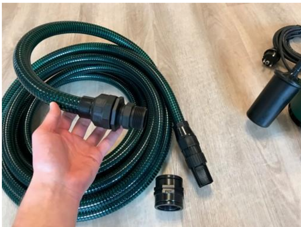
Stap 2: Neem het uiteinde van de slang en schroef de gehele koppeling eruit.
