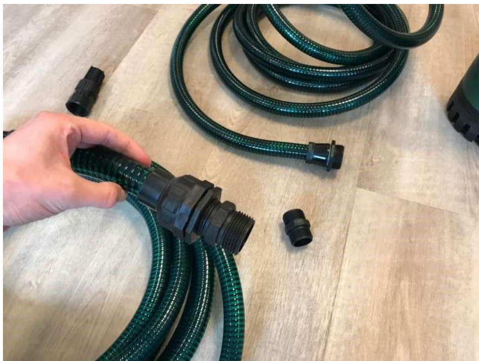
Étape 3 : Prenez l'extrémité « large » du deuxième tuyau et dévissez le raccord entier.
