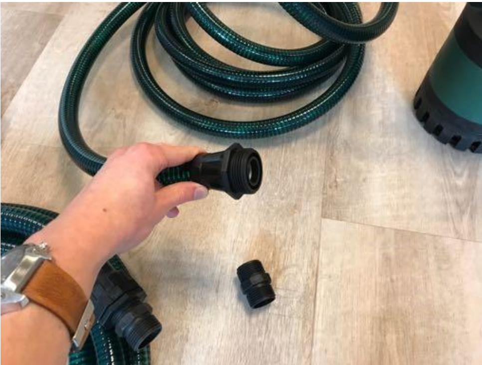
Stap 2: Draai de verlooping op het uiteinde van de eerste slang.
