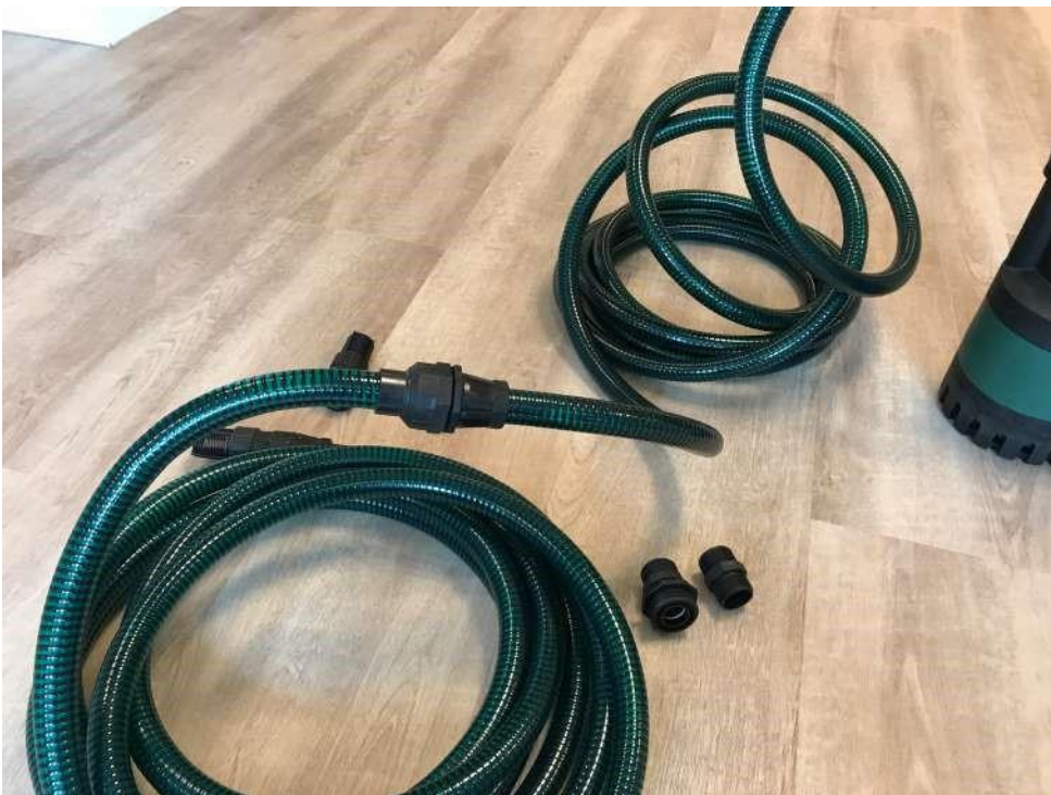
Étape 4 : Raccordez les extrémités du premier et deuxième tuyau.
