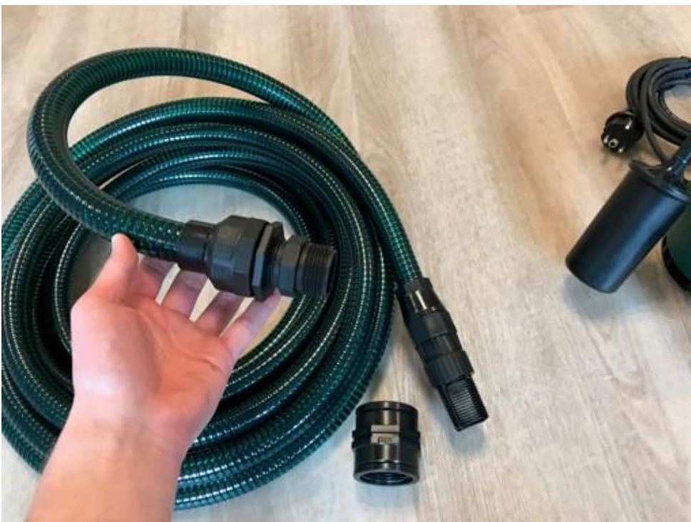
Schritt 2: Schrauben Sie die gesamte Kupplung aus dem Schlauchende.
