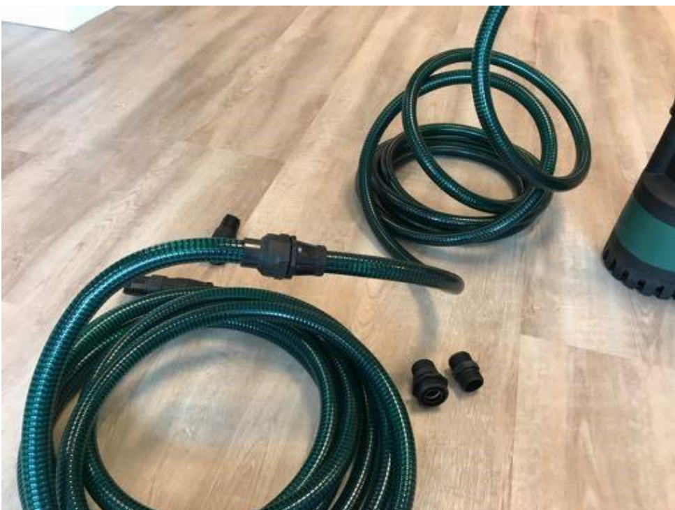
Stap 4: Koppel de twee uiteindes van de eerste en tweede slang aan elkaar
