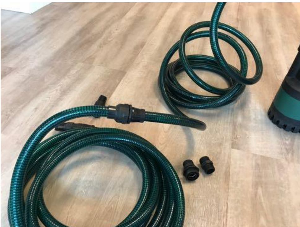
Schritt 4: Verbinden Sie die beiden Enden des ersten und zweiten Schlauchs miteinander.
