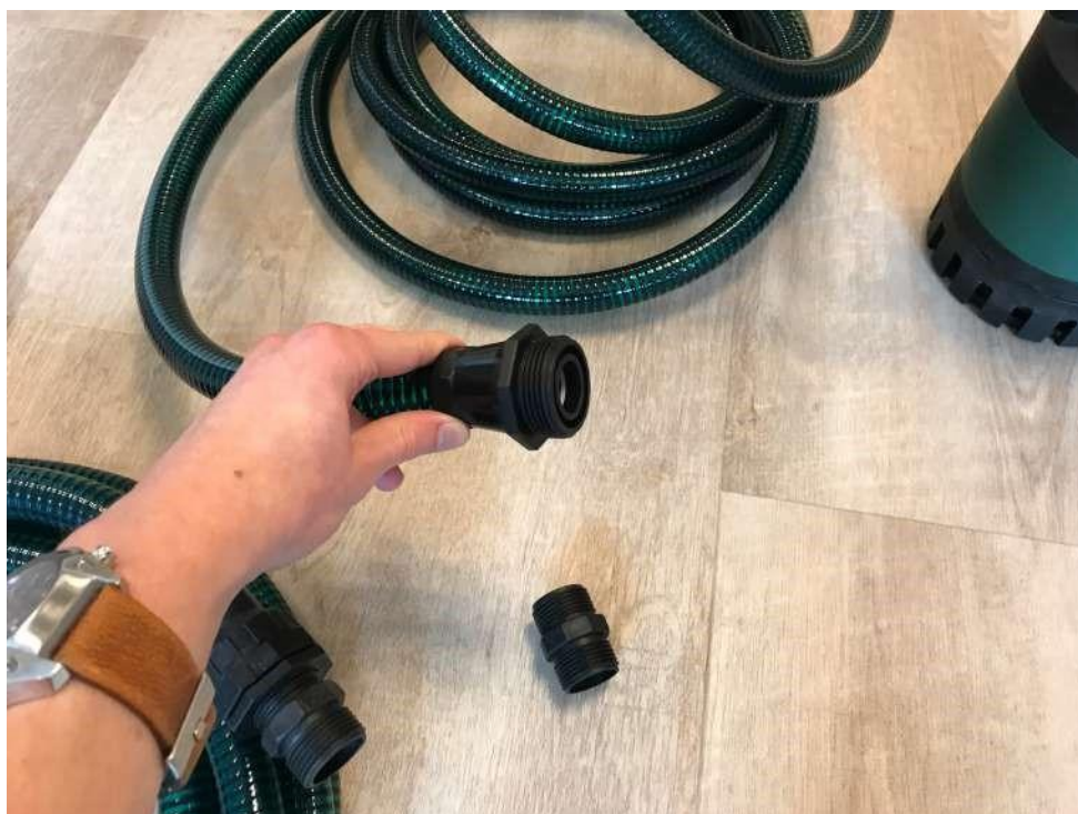
Étape 2 : Vissez la réduction sur l'extrémité du premier tuyau.
