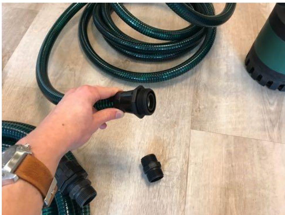
Fase 2: Avvitare l'anello adattatore all'estremità del primo tubo.
