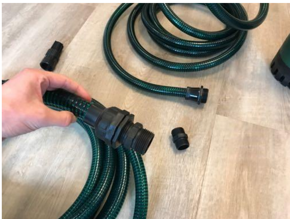
Fase 3: Dall'estremità "larga" del secondo tubo flessibile svitare l'intero raccordo
